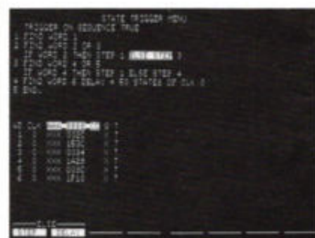
Afb. 7. Het status triggermenu laat zes verschillende triggerwoorden en twee conditionele vertakkingen zien.
