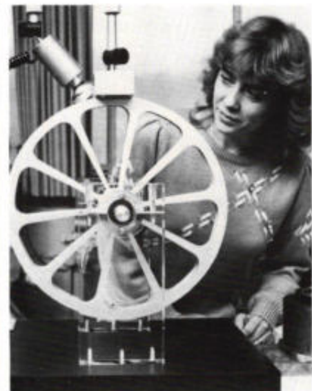
Fig. 10. De curiemotor zet warmte om in bewegingsenergie.
