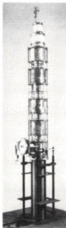
Afb. 5a. De Valvo klystron V107SK, een microgolfbuis met een hoogte van 4m.
