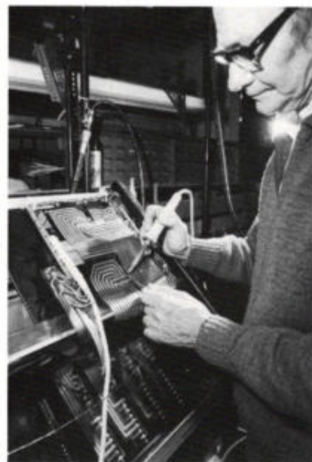
Afb. 7. De toepassing van flexibele gedrukte bedrading levert geen problemen op voor het montagepersoneel dat gewend is aan conventionele bedrading. Polyimide-film kan tegen temperaturen van 200 °C en meer.
