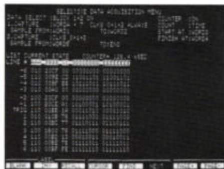
Afb. 3. Combinatie van softkey-invoer en een beknopt menu in de uitlezing maakt bediening van de PM 3551 uiterst eenvoudig.
